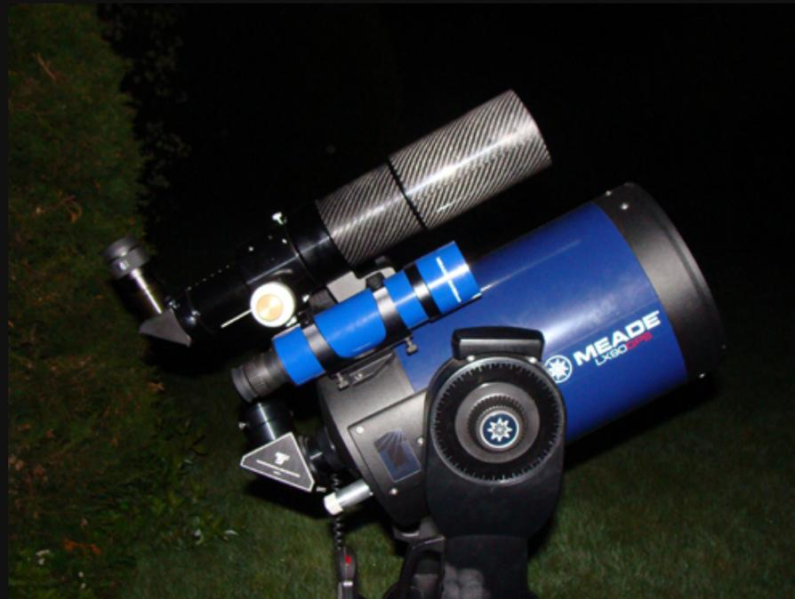
Azimutale Montierung, inkl. Piggyback-Halterung mit ED70-Refraktor
