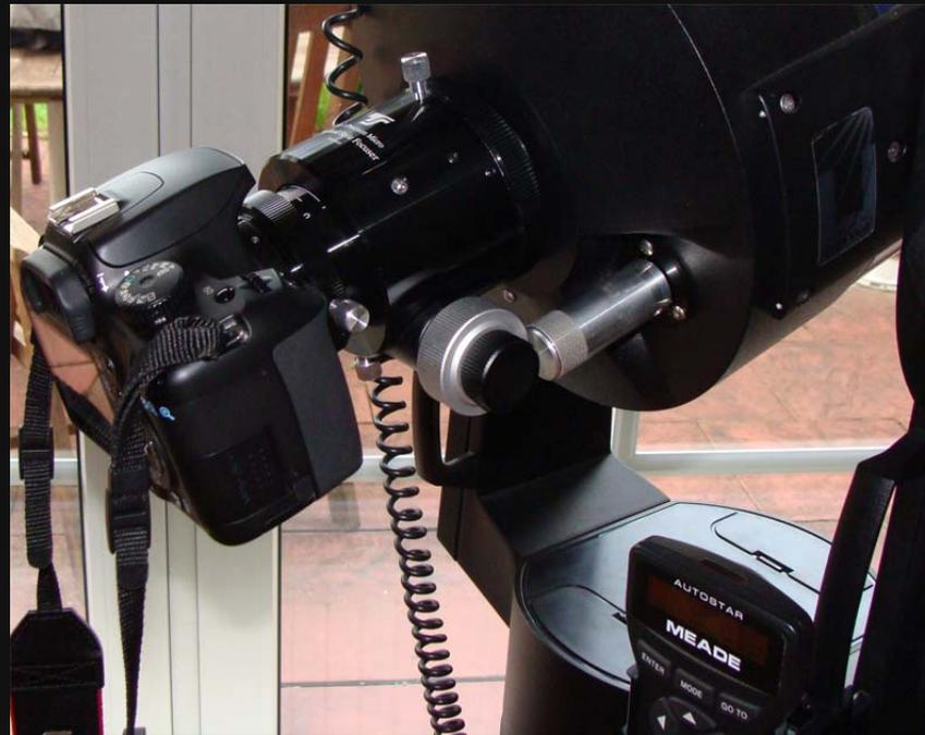
Azimutale Montierung mit 8" Schmidt-Cassegrain-Teleskop LX90 und
