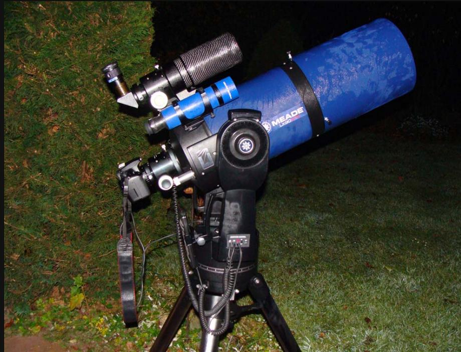
Azimutale Montierung LX90 mit aufgesatteltem ED70 und Taukappe
