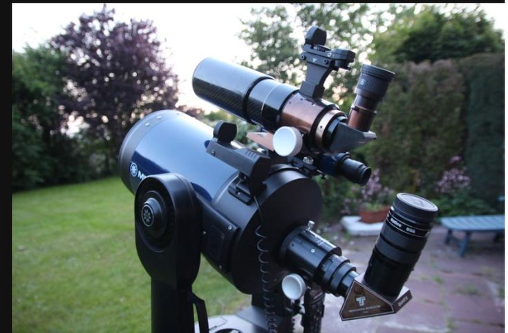
8" SC-Teleskop mit azimuthaler Gabelmontierung und aufgesatteltem ED70-Refraktor
