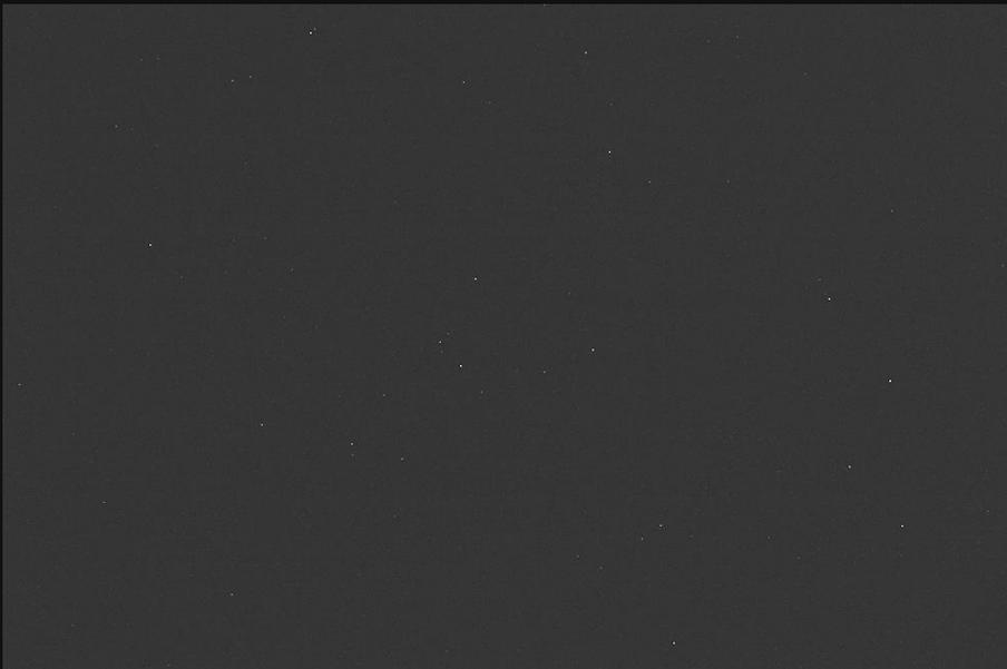
Dark-Frame, ASI 2600MCpro bei Gain 100, 5 min Belichtung,  $-10^{\circ}$  C
