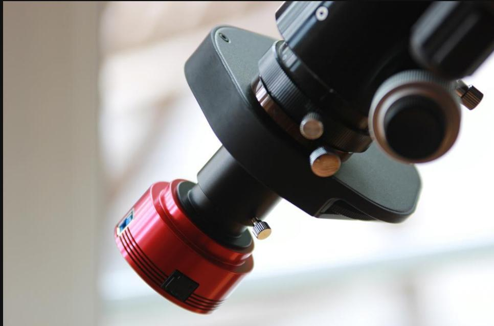
A.S.I. 178MM USB3.0-Kamera mit Filterradd an einem Crayford-Auszug
