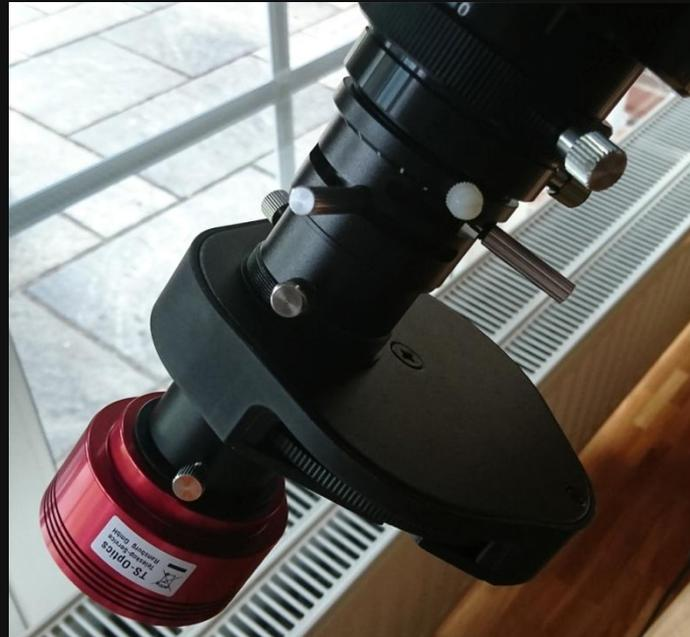
Planetenkamera mit Filterrada und ADC
