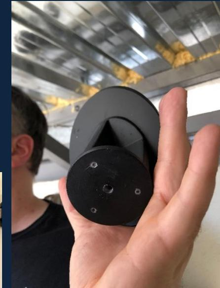
Zu einfacher Aufbau der Fangspiegelhalterung
