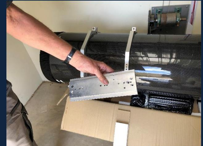
Fehlende 3"-Schiene trotz Komplettlieferung
