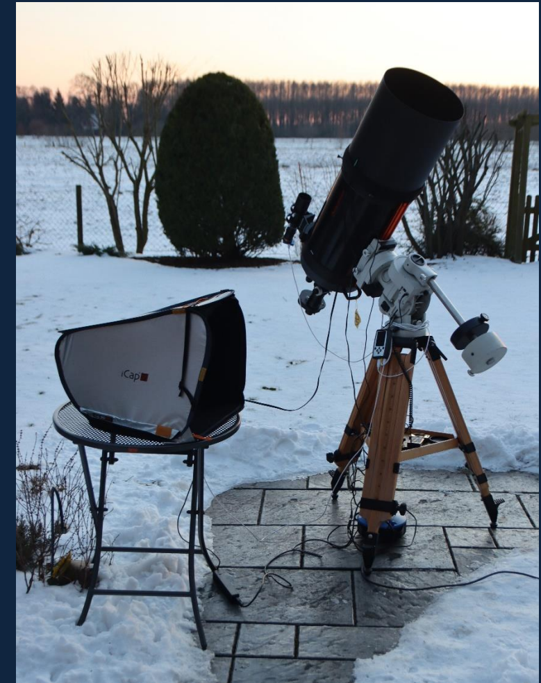
Eigenes Astro-Equipment: C11-Teleskop, CEM60-Montierung, M-GENV3 Autoguider
