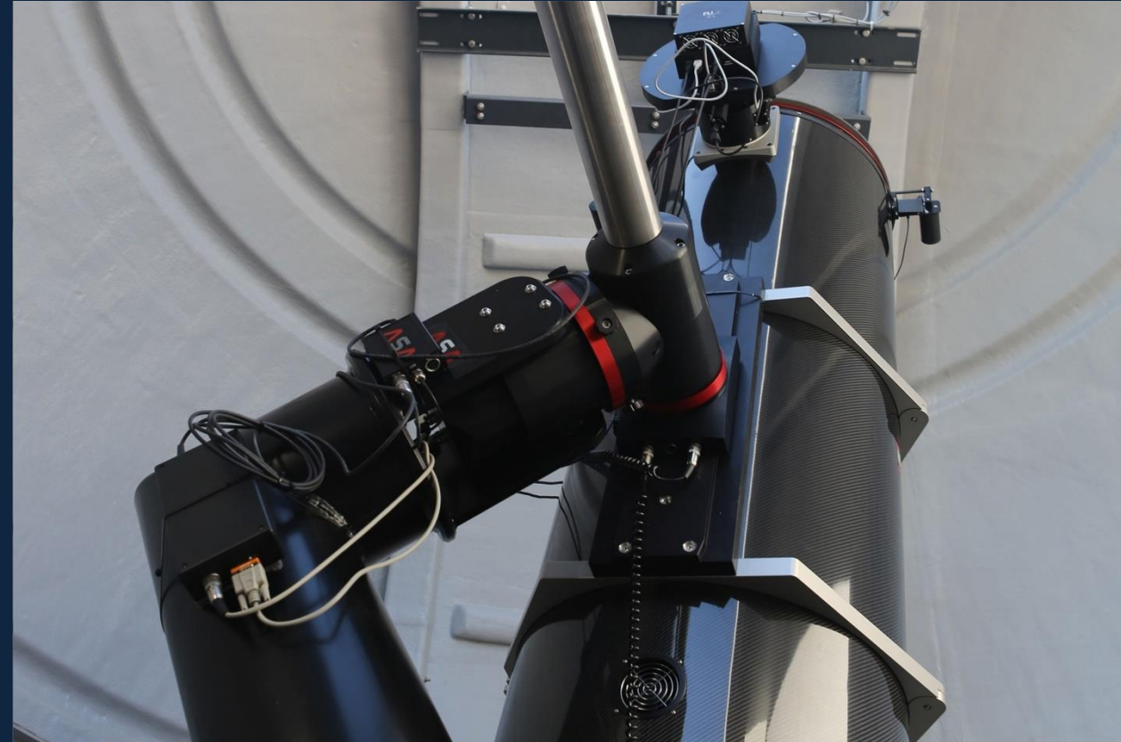
ASA 500N, 50 cm F3.8 korrigiertes Newton-Teleskop am Standort Rio Hurtado Valley in Chile
