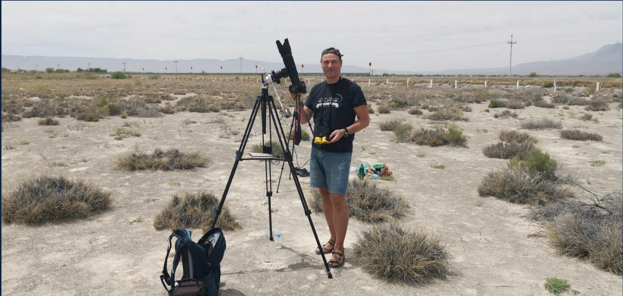
SoFi-Equipment: AstroTrac-Reisemontierung, Powerbank zur Stromversorgung, Fernauslöser, 70-200 mm Sigma-Teleobjektiv, 2fach Telekonverter, Kamera Canon 90Da, Hoya HMC-NDX400-Filter
