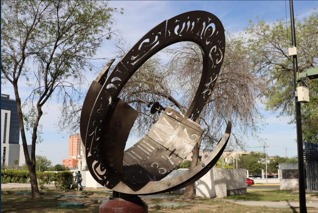
Sie ist zusammengesetzt aus zwei halbkreisförmigen Trägern als Meridiane, einer Mittelachse parallel zur Erdrotationsachse und einem großen Äquatorkreis, der zwei Streifen trägt, die in römischer und arabischer Sprache nummeriert sind.
