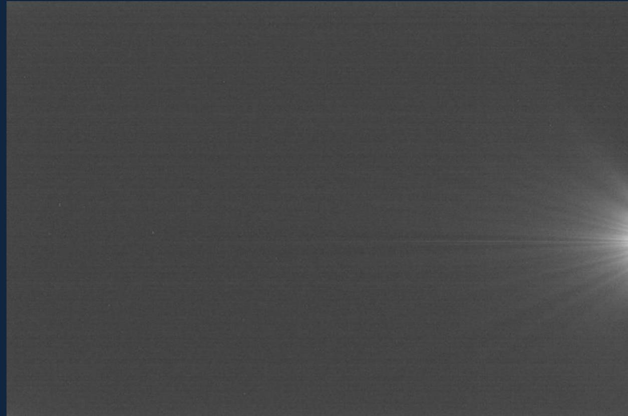
Dark-Frame ASI 183MCpro bei Gain 0 und 5 min Belichtung, -10 Grad Celsius
