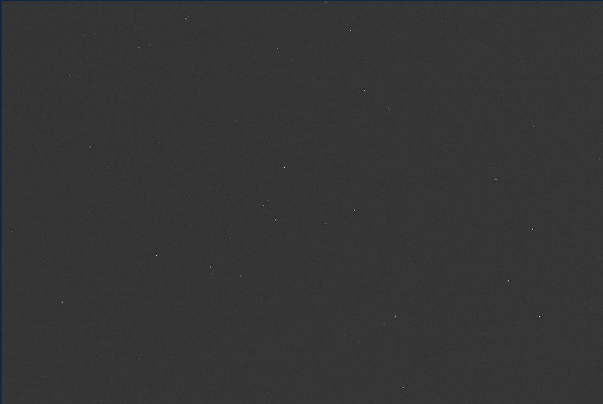
Dark-Frame, ASI 2600MCpro bei Gain 100 und 5 min Belichtung, -10 Grad Celsius
