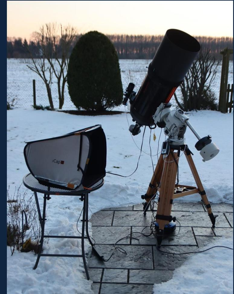
Eigenes Astro-Equipment: C11-Teleskop, CEM60-Montierung, M-GENV3 Autoguider
