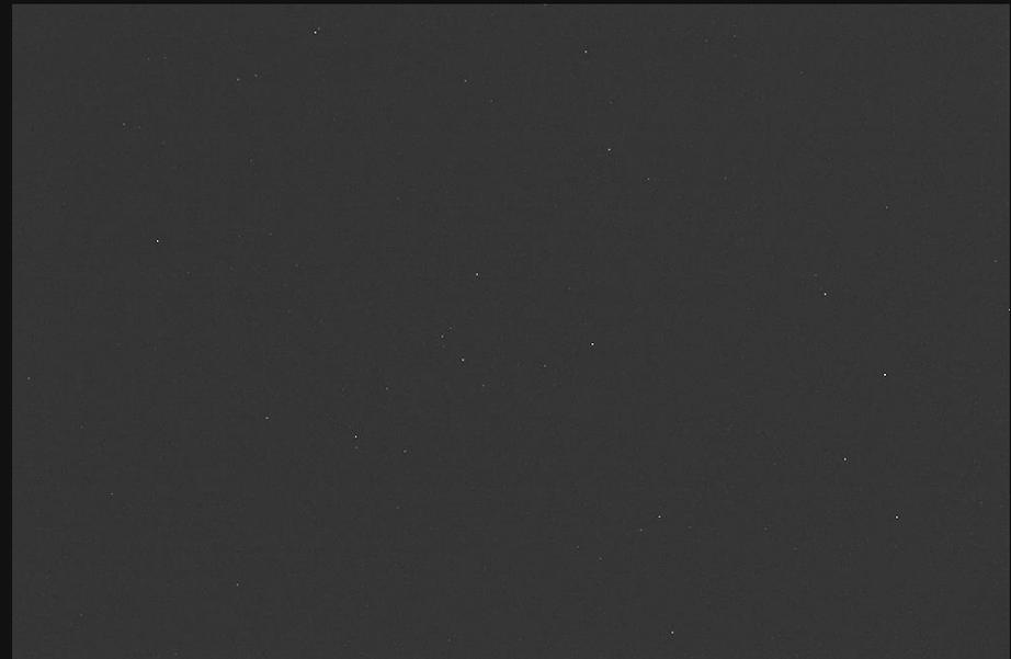
Darkframe A.S.I.2600MCpro bei Gain 100 und 5 min Belichtung
