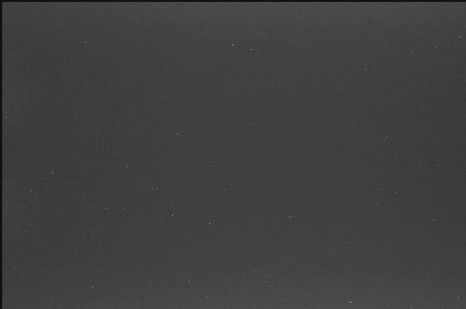
Darkframe A.S.I.071MCpro bei Gain 90 und 5 min Belichtung
